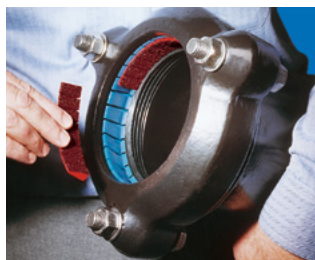
Ej dragfast produkt – Ta bort låskilarna
